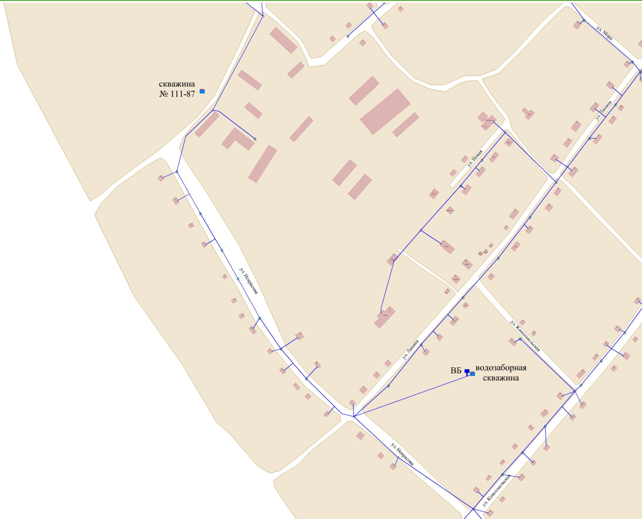
Рисунок 5.2 – Схема существующего размещения объектов централизованной системы водоснабжения
